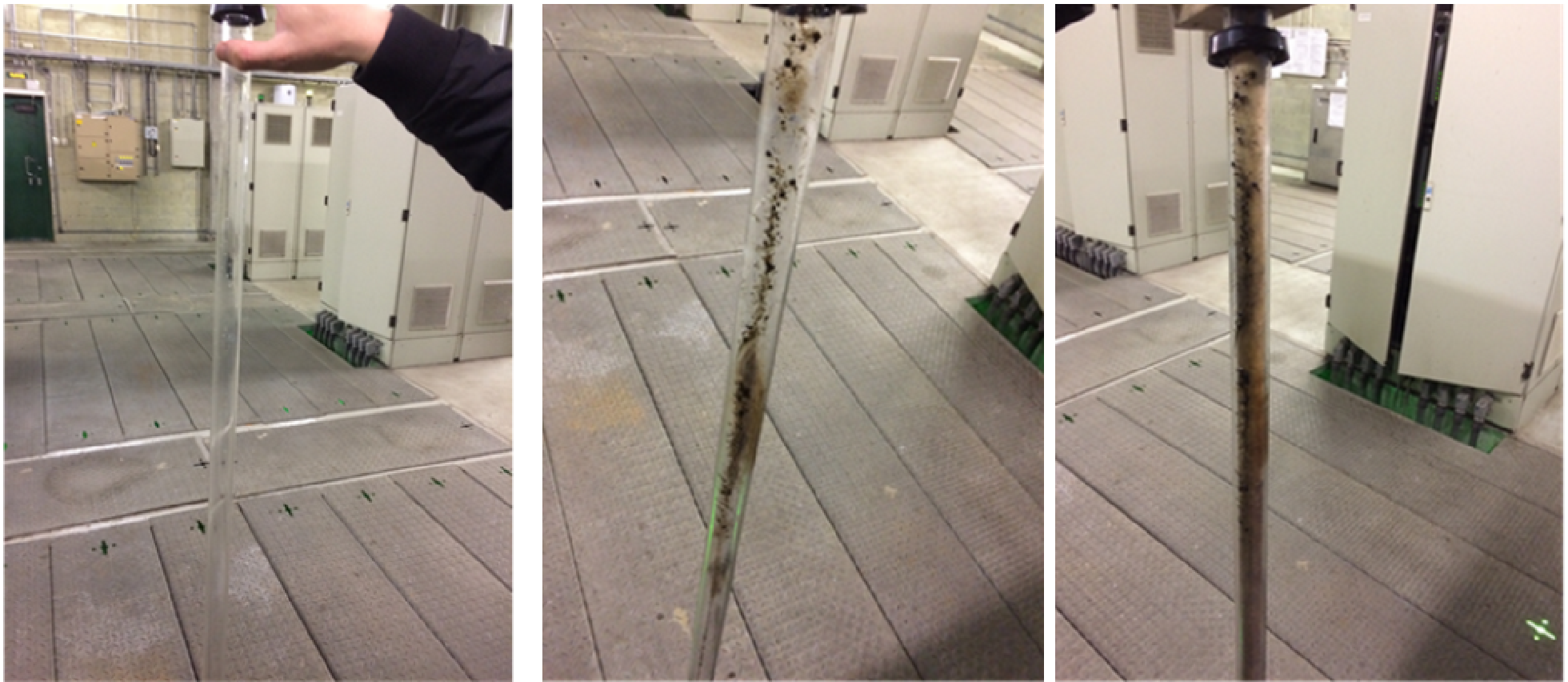
Рисунок 3 – Кварцевые чехлы УФ-ламп сразу после извлечения из Установки, отработавшей в режиме УФО-контроль
