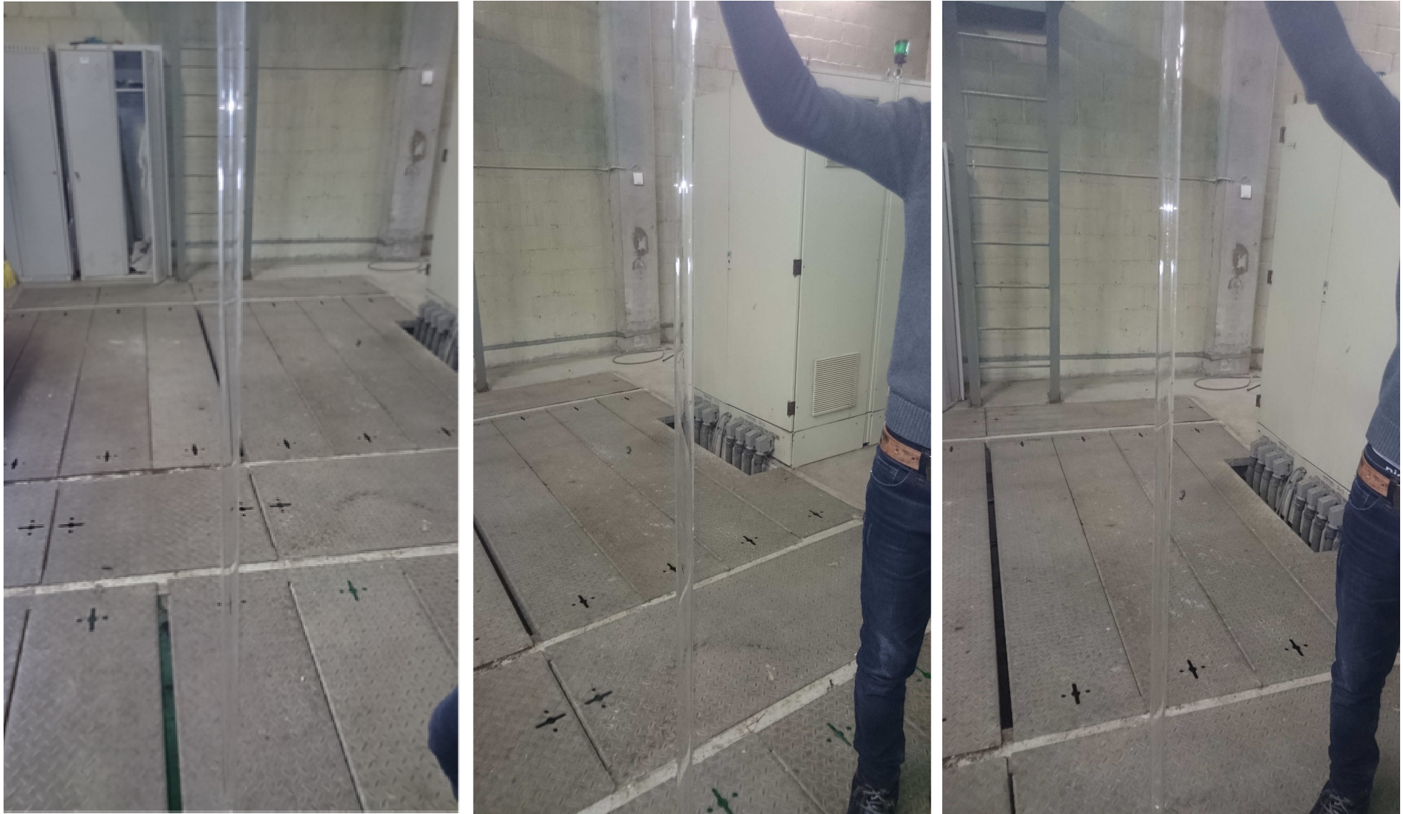
Рисунок 4 – Кварцевые чехлы УФ-ламп сразу после извлечения из Установки, отработавшей в режиме УЗО+УФО
